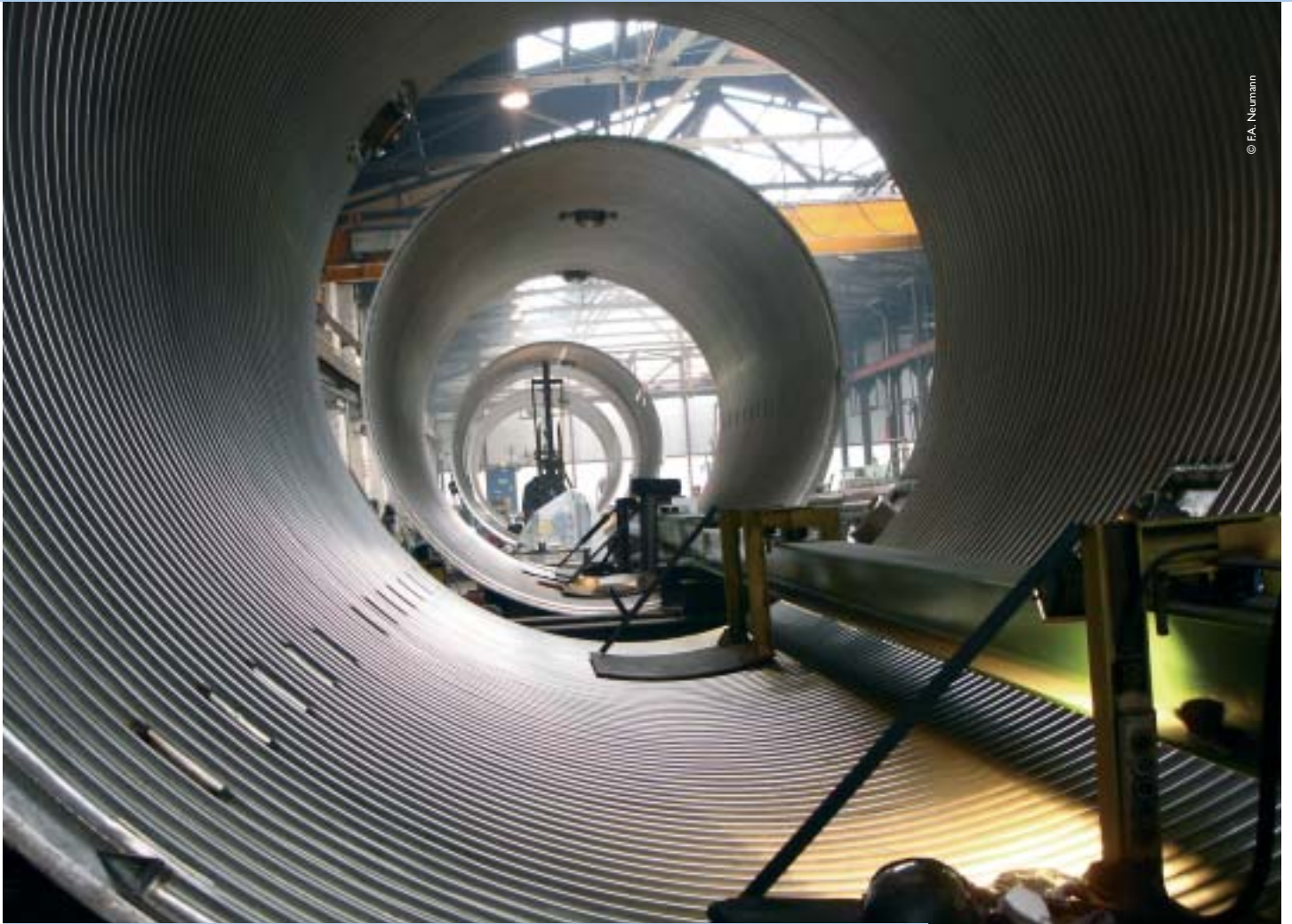
Трубы системы охлаждения, сваренные порошковой проволокой компании BÖHLER WELDING
